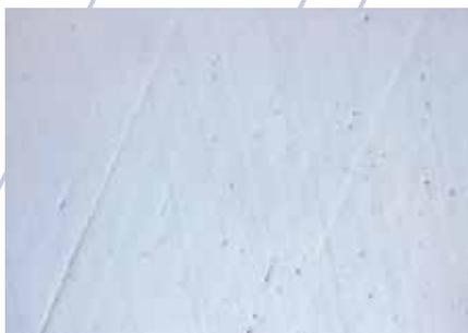
Rostfreier Stahl nach 3 µm Politur mit Restverformung vom Schleifen
