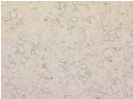
Abb. 8: Austenit mit Karbiden und einigen Titankarbonitriden 200x
