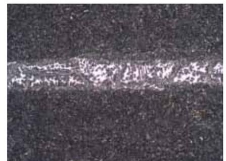
Abb. 6: Angelassener martensitischer rostfreier Stahl mit Delta-Ferrit, geätzt mit Pikrinsäure 75x
