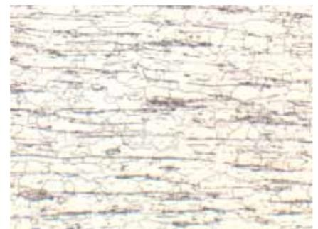
Abb. 5: Ferritischer rostfreier Stahl mit Zeilen von Mangansulfiden und kleinen Karbiden, elektrolytisch geätzt mit 10% Oxalsäure 200x
