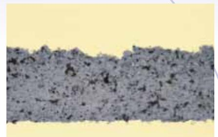
Abb. 2: Gleiche Schicht wie in Abb. 1, richtig poliert
