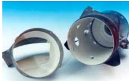
Verbrennungskammer mit APS Wäremedämmschicht, Haftschicht aus NiCrAlY, Deckschicht aus  $ZrO_2 + Y_2O_3$
