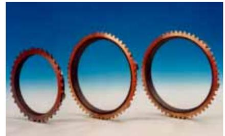
Synchronringe aus Sondermessing flammgespritzt mit Molybdänbeschichtung gegen Verschleiß
