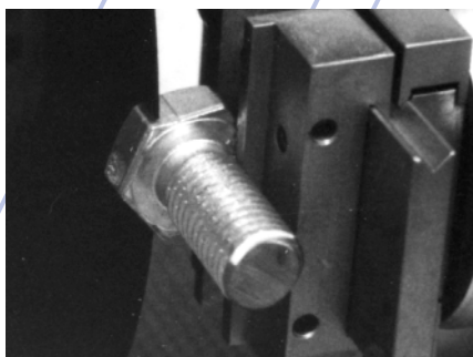
Teil des Schraubenkopfs wird vor dem Einbetten abgetrennt
