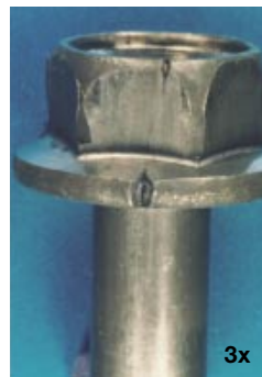
Abb.7a: Riss im Kopf eines Bolzens aus Kohlenstoffstahl entstanden durch Walznaht
