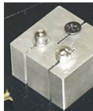
Abb. 3: Spezialhalter zum Trennen von Schrauben
