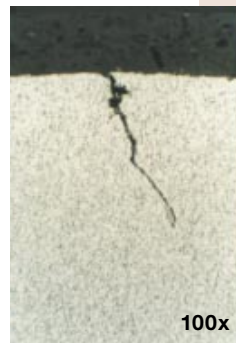
Abb.7b: Querschliff durch Riss aus Abb. 7a. Ätzung: 3% Nital
