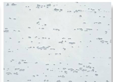
Abb. 5: Wie Abb. 4, warmgewalzt, ungeätzt, 200x.
