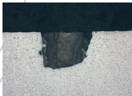
Abb. 2: Oxid an der Oberfläche eines Aluminium-Druckgussteils, 50x.
