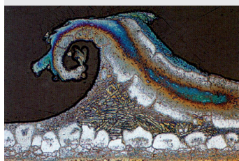
Abb. 17: Grat an einer Lotverbindung eines Wärmetauschers, vorgeätzt mit Natriumhydroxid, geätzt mit Kaliumpermanganat-Farbätzung nach Weck.
