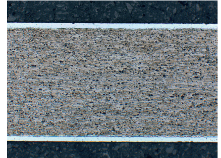
Plattiertes Blech, Kern Al-Legierung 2024, Plattierung: Aluminium 99,5%, geätzt mit Dix und Keller, 50x.
