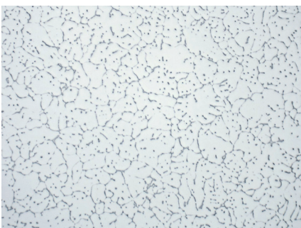
Abb. 3: Al-Legierung 2024, Gusszustand, eutektisches Korngrenzengerüst, ungeätzt, 200x.
