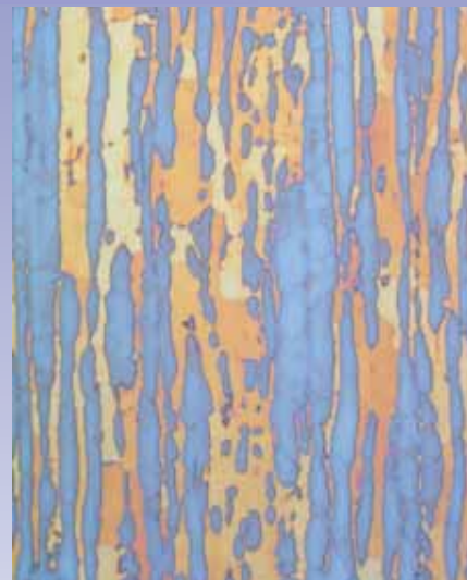
Fig. 1: Acier duplex, attaqué avec une solution aqueuse 40% d'hydroxyde de sodium, montrant une austénite bleue et un ferrite jaune
