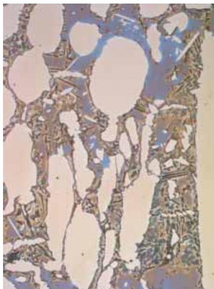
Fig.10: Acier duplex forgé montrant de la ferrite bleue, de l'austénite blanche et de fines aiguilles de phase sigma, réactif d'attaque hydroxyde de sodium aqueux 40%.
