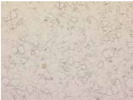
Fig. 8: Austénite avec carbures et quelques carbonitrides de titane 200x
