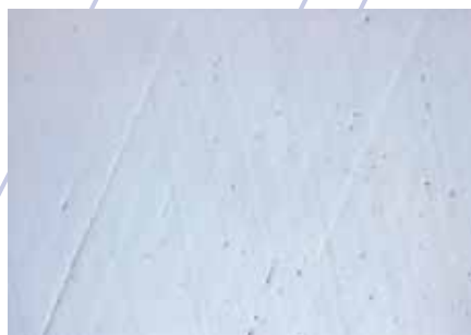
Surface d'un acier inoxydable après polissage 3 µm, montrant une déformation de prépolissage
