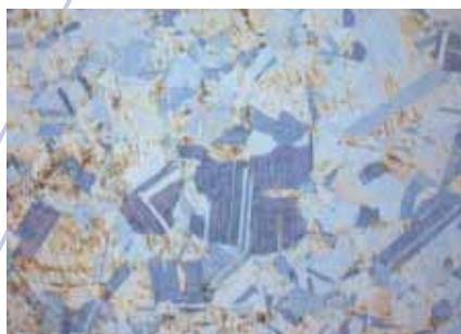
Acier inoxydable insuffisamment poli après attaque colorante (Beraha II), montrant des déformations
