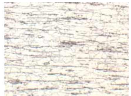
Fig. 5: Acier inoxydable ferritique avec sulfides de manganèse et fils de petits carbures, après attaque électrolytique à l'acide oxalique 10% 200x
