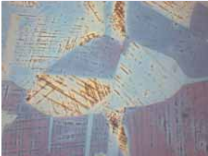
Fig. 3: Acier austénitique, insuffisamment poli, 500x montrant des déformations après l'attaque (Beraha II)
