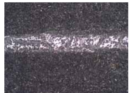
Fig. 6: Acier inoxydable martensitique revenu avec ferrite delta, après attaque à l'acide picrique
