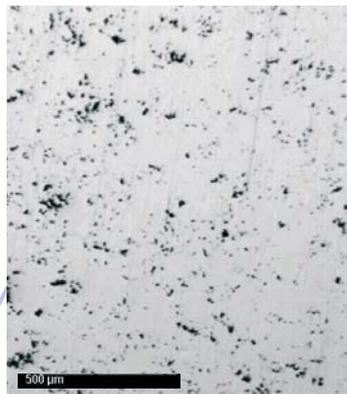
Fig. 1: Porosité dans un échantillon d'acier M/P après un polissage de 4 min. au diamant 3µm
