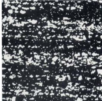
Fig. 4: Répartition du carbure dans de l'acier produit de façon conventionnelle
