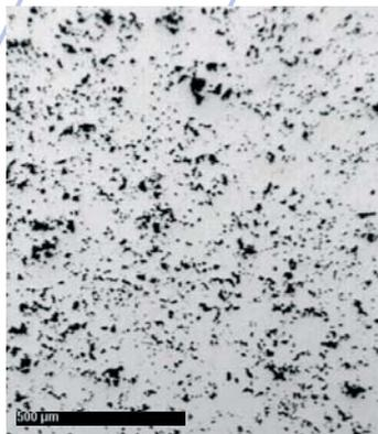
Fig. 2: Même échantillon qu'à la Fig. 1 après un polissage de 8 min. au diamant 3µm
