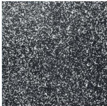
Fig. 5: Répartition du carbure dans de l'acier en poudre métallurgique
