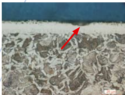
Fig. 2: Sans netteté des bords, la mise au point de la couche n'est pas claire à grossissement élevé
