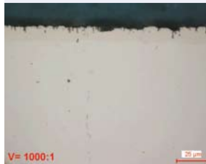
Fig. 14: Acier allié (16MnCr5 N) nitrocarburé en bain de sel, enrobé sans feuille de cuivre. L'on peut observer un écaillage de la couche de nitrure et la mince couche d'oxyde ne peut pas être distinguée de la résine d'enrobage.
