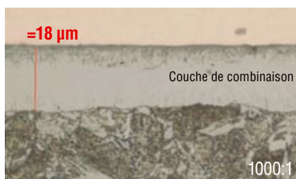
Fig. 3: Détails de la composition d'une couche nitrurée
