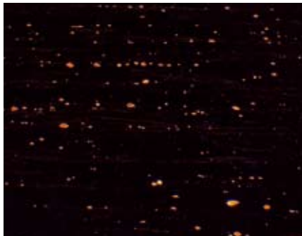
Fig. 5: Cuivre avec oxydes de cuivre rouge, fond noir, 500x.
