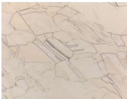
Fig. 6: Cuivre exempt d'oxygène, attaqué au peroxydi-sulfate d'ammonium, 100x.
