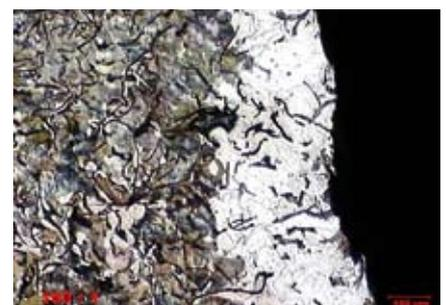
Fig.17: Pareil que la fig. x, après prépolissage fin diamanté sur MD-Largo, montrant une bonne netteté des bords
