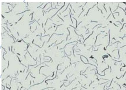
Fig. 2: Pareil à Fig.1, mais après polissage correct 200x
