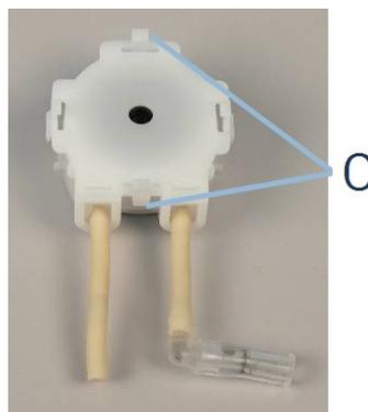
4. Drücken Sie die beiden Plastiknasen an der Pumpe (C) gegeneinander und entfernen Sie den Boden der Pumpe.
