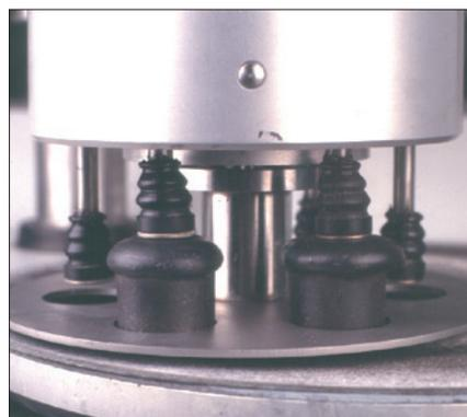
Abb. 13: Probenhalter zum halb-automatischen Polieren von Gussproben zur Qualitätskontrolle in der Gießstraße
