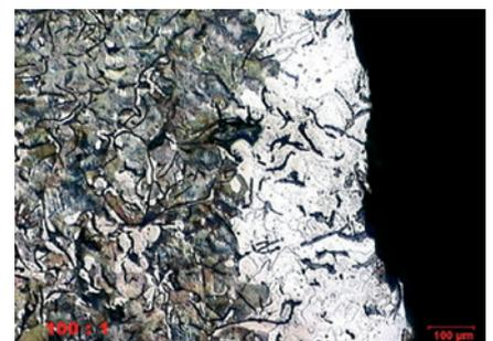
Abb.17: Gleiche Probe wie in Abb.16, mit Diamant auf MD-Largo feingeschliffen, zeigt gute Kantenschärfe
