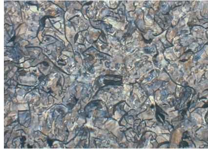
Abb. 4: Gusseisen mit Lamellengraphit, perlitisches Grundgefüge 200x
