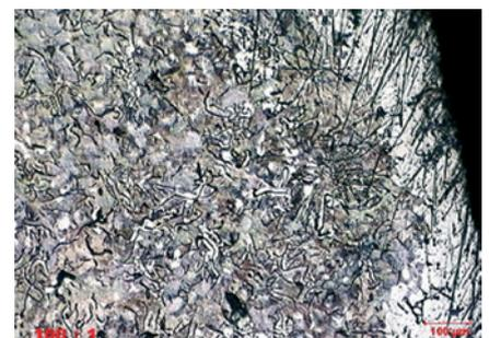
Abb.16: Grauguss mit SiC-Papier feingeschliffen, Schliffkante nicht flach, noch starke Kratzer
