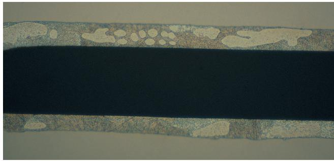
Fig. 9: Revêtement Galfan, attaqué au Nital 0,5%. Structure dendritique primaire, 500 x
