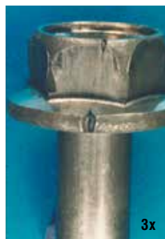
Fig. 7a: Fente causée par point de soudure dans la tête d'un boulon en acier au carbone
