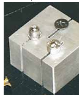
Fig. 3 : Porte-échantillons spécial pour le tronçonnage des vis
