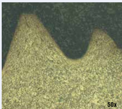
Filetage d'un boulon, acier trempé allié. Réactif d'attaque: 3% de nital
