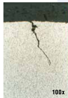
Fig. 7b: Section transversale du point de soudure de la Fig. 7a. Réactif d'attaque: 3% de nital
