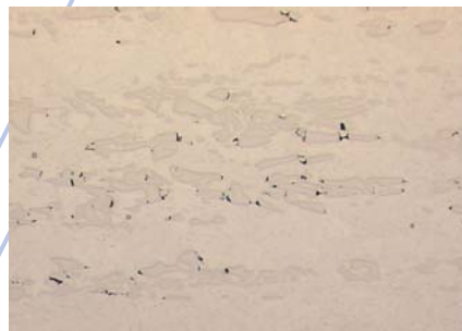
Fig. 2: Carbures primaires fracturés
