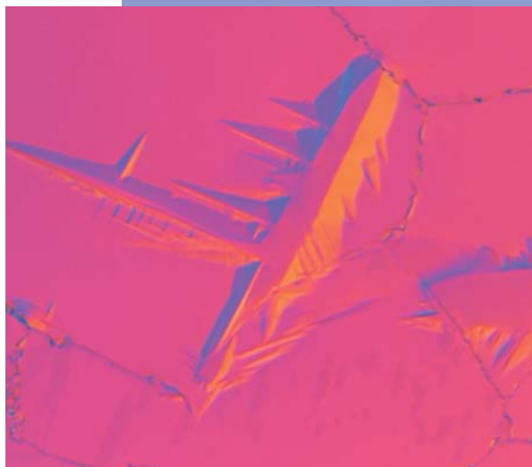
Acier pour moulage du plastique, attaqué au Picral 5%, révélant des aiguilles et plaques étranges à grossissement élevé dans une martensite qui habituellement est amorphe
