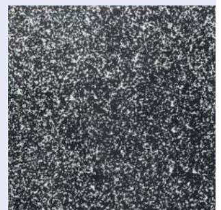
Fig.12: Répartition des carbures dans de l'acier produit par métallurgie des poudres
