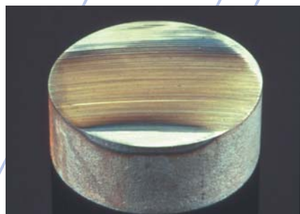
Fig. 1: Dommages thermiques dus à des conditions de tronçonnage erronées
