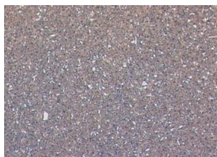
Fig.4: Acier à outils pour travail à froid, attaqué au Nital 10%, les carbures primaires apparaissent en blanc 100x
