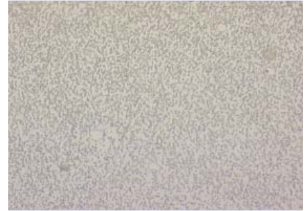
Fig.10: Acier pour moulage du plastique après recuit, montrant des carbures très fins
