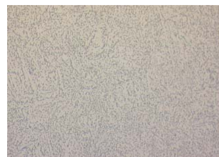
Fig.5: Acier à outils pour travail à chaud, attaqué au Picral et Nital, perlite globulaire 500x
