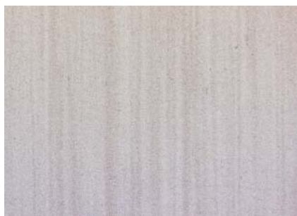
Fig. 8: Acier à outils pour travail à chaud montrant des ségrégations
