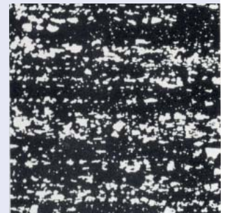
Fig.11: Répartition des carbures dans de l'acier produits traditionnellement
