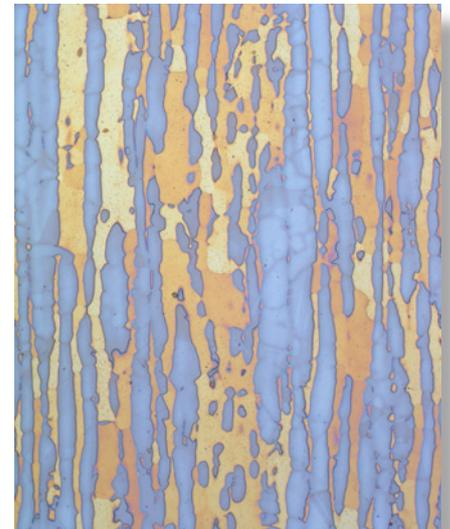
Fig. 1: Acier duplex, attaqué avec une solution aqueuse 40% d'hydroxyde de sodium, montrant une austénite bleue et un ferrite jaune
