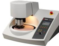
Les revêtements métalliques peuvent être polis fin soit au diamant 1 µm, soit à la silice colloïdale (OP-U NonDry) à l'aide d'un drap doux. Il n'est pas recommandé d'utiliser une suspension de silice colloïdale OP-S NonDry pour polir les revêtements par projection de métaux car un relief trop important apparaît. Toutefois, OP-S NonDry convient pour le polissage final de revêtements céramique car cela améliore le contraste de la structure.
