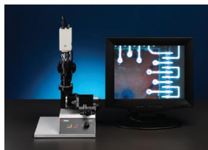
Fig. 11 : Vidéo cible Z pour positionnement et mesure de cibles visibles
