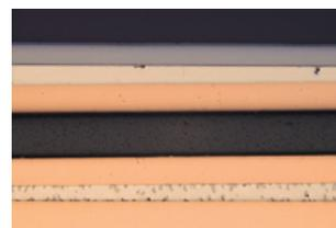
Fig. 5 : relief de polissage dû aux différentes duretés des matériaux
