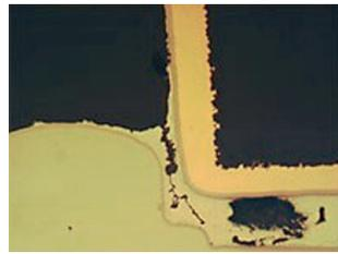
Grand vide dans la soudure d'une connexion par trou métallisé. 50 x
