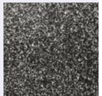
图12：采用粉末冶金法生产的钢材中碳化物的分布情况
