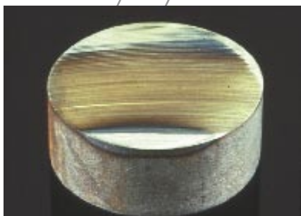
图1：切割条件不当导致的热损伤
