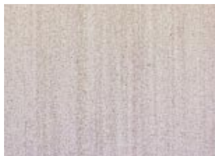
图8：呈现偏析现象的热加工工具钢
