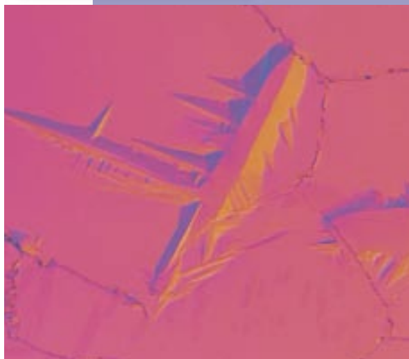
塑模钢用5%苦味酸浸蚀溶液蚀刻后，原本无定形的马氏体经过高倍放大显现出一些单体针状和板状。
