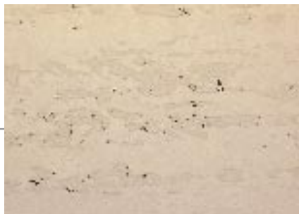
图2：破裂的一次碳化物
