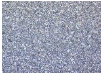
图7：经过充分热处理后，冷加工工具钢呈现出微细弥散分布的二次碳化物和细小白色的一次碳化物
