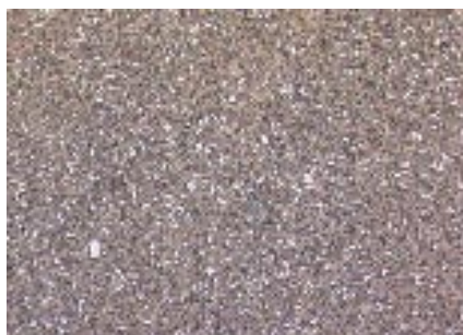
图4: 用10%奈塔尔硝酸乙醇腐蚀液蚀刻后的冷加工工具钢可突出显现出白色的一次碳化物。
