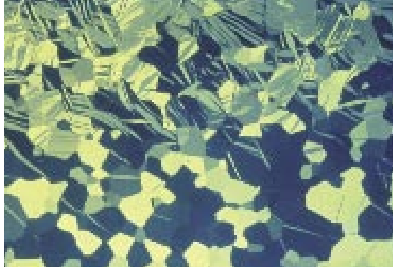
图9： 工业纯钛的晶粒结构，偏振光，100 x
