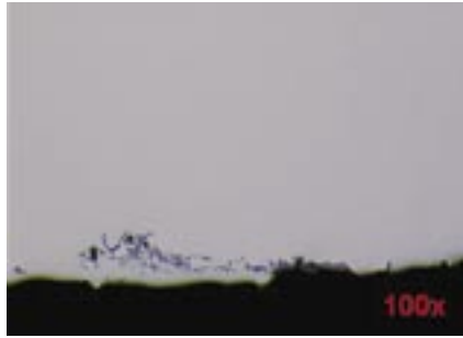
图3：轧入钛条表面的灰色氧化物
