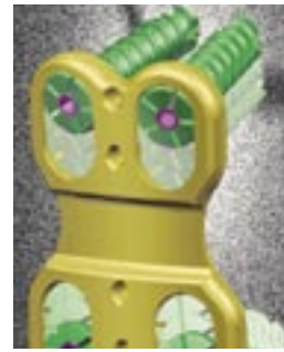
图5：骨板和螺钉，通过电化学氧化来进行彩色编号。颜色不同是因为氧化物厚度不同造成的
