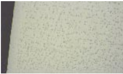
图7: 用3μm金刚砂抛光后的钛金属, 未能消除变形与划痕。
