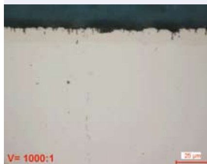
图14: 合金钢 (16MnCr5N), 盐浴氮碳共渗, 无铜箔镶嵌。渗氮层剥落, 且不能从镶嵌树脂中鉴别薄氧化层。
