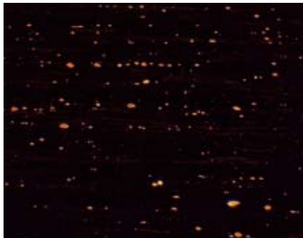
图5：铜夹杂红色氧化铜，暗场，放大500x
